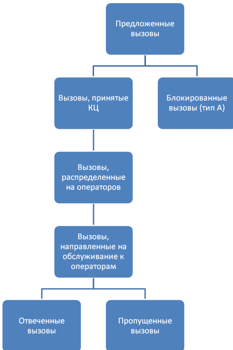
Рисунок 6. Классификация входящих телефонных вызовов в контексте их обработки при отсутствии IVR и наличии автоматического приветствия (во время приветствия вызов находится в очереди)/отсутствии автоматического приветствия. Алгоритм искусственной блокировки (тип В) отсутствует
